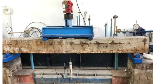
Hình 6. Thí nghiệm uốn dầm BTCT theo sơ đồ 4 điểm
