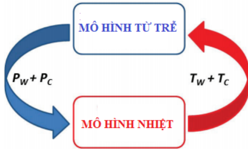
Hình 1. Mô hình nghiên cứu sự tác động qua lại từ – nhiệt
