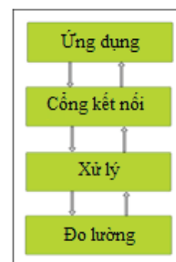
Hình 2. Sơ đồ khối đơn giản về các khối xây dựng cơ bản của IoT.
