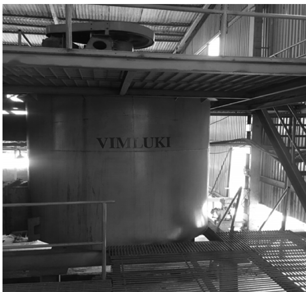
Hình 1. Thiết bị tuyển nổi tankcell 8 m 3 chế tạo của Đề tài
